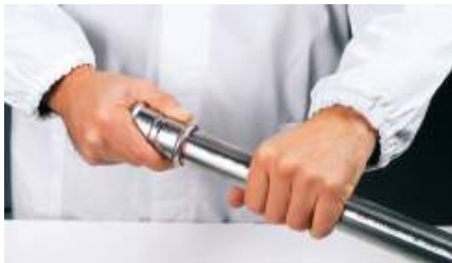
31.ábra - A cső behelyezése a présidomba.
